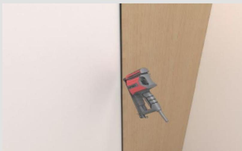
4. Insira o perfil metálico na ranhura a partir da lateral do painel e em seguida fixe o perfil metálico na parede. (parafuso 3,5x35mm);
